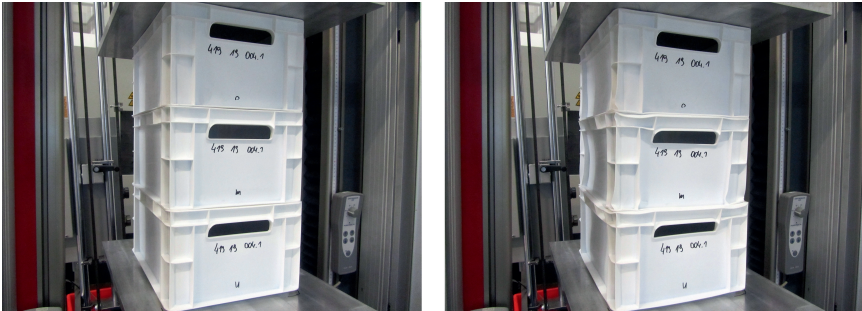
Bild 3. Stapeldruckversuch mit drei übereinander gestapelten Transportboxen mit Sandwich-Aufbau. Links: ohne Druckbelastung. Rechts: Starke Druckbelastung führt bei den Boxen erkennbar zu einer Stauchung der Seitenwände und Verstärkungsrippen © Transfocenter für Kunststofftechnik
